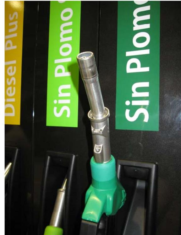
Los boqueroles de RV no acoplan herméticamente al depósito del vehículo. Parte de los vapores se emiten a la atmósfera.
