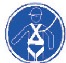
Protección individual obligatoria contra caída en trabajos a más de 3,5 m. y recomendable a partir de 2 m.
