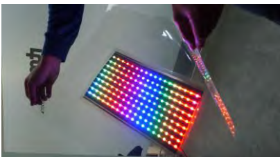
Desarrollo y demostración de un módulo multifuncional flexible, basado en ETFE, para iluminación arquitectónica de fachadas. FUNDACIÓN ITMA.
